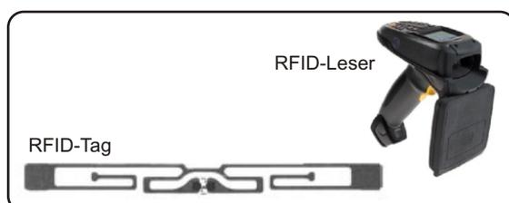
Die RFID-Tags, jeder mit einer eindeutigen Identifikationsnummer versehen, sind schreib- und lesbar und enthalten neben Informationen über Bauteilart und Nummer auch den Servicestand der Anlage. Dieser wird nach jedem Bearbeitungsschritt aktualisiert und vor der nächsten Servicetermin ausgelesen.
