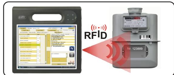
RFID-Tag am Stromzähler und PC mit mobilem RFID-Leser
